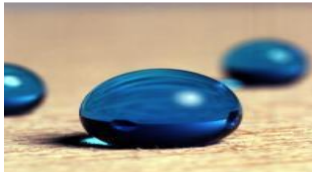
شکل ۳- عدم نفوذ قطرات آب در مواد سوپر هیدروفوبیک [۹]
